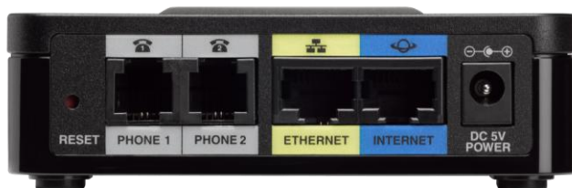
Figura 2. Porte su Cisco SPA 122 ATA con router
