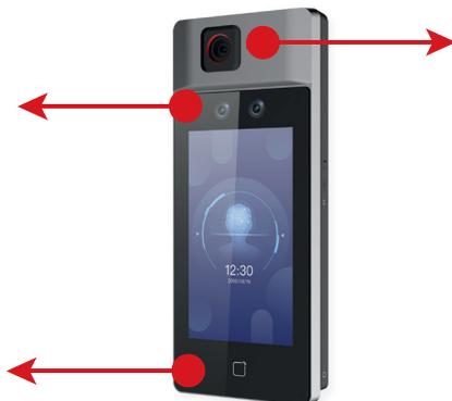
**Rilevazione della temperatura:** la presenza dell'ottica termografica grandangolo, unita all'intelligenza artificiale a bordo del dispositivo, garantiscono l'accurata ed immediata rilevazione della temperatura lungo l'intera superficie del display.
